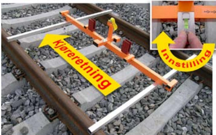
1. Registrér nivå på skinnegang.
