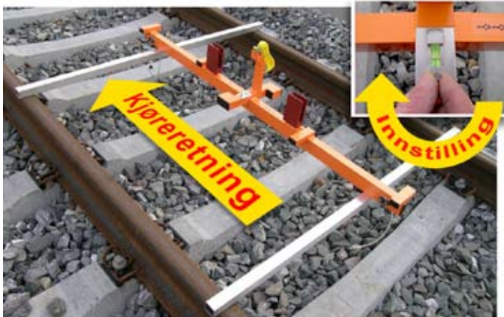
1. Registrér nivå på skinnegang
